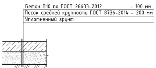
КОНСТРУКЦИЯ ПОКРЫТИЯ ТИП "Щ-1"
