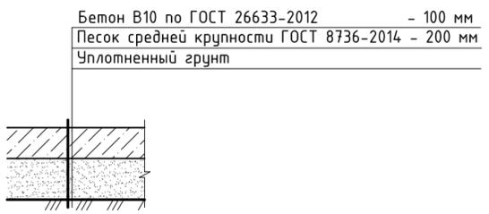
КОНСТРУКЦИЯ ПОКРЫТИЯ ТИП "Щ-1"
