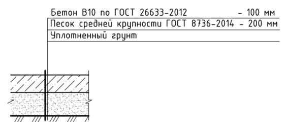
КОНСТРУКЦИЯ ПОКРЫТИЯ ТИП "Щ-1"
