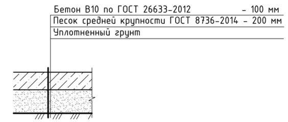
КОНСТРУКЦИЯ ПОКРЫТИЯ ТИП "Щ-1"
