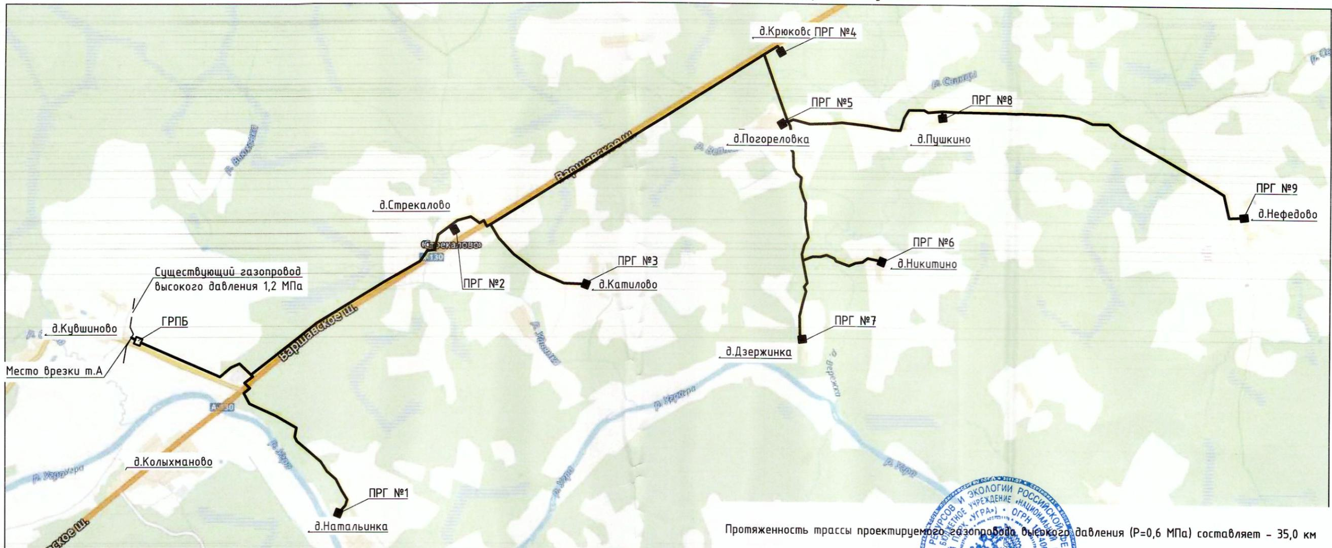
Протяженность трассы проектируемого газопровода высокого давления (P=0,6 МПа) составляет - 35,0 км
